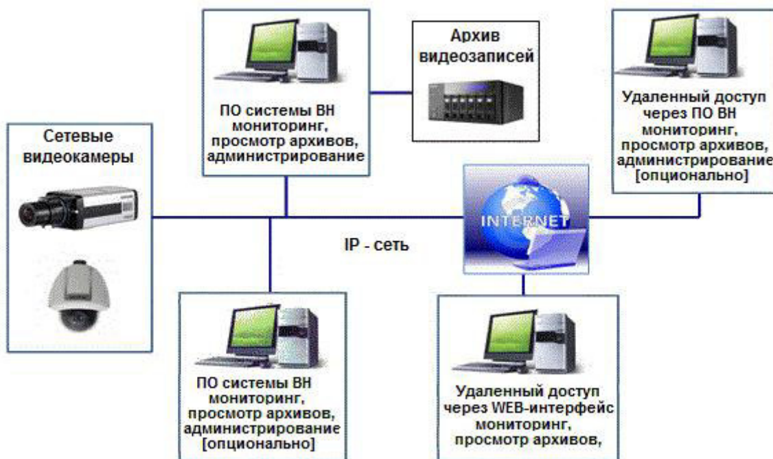
Рис. 6.17. Вариант системы видеонаблюдения на базе сервера
