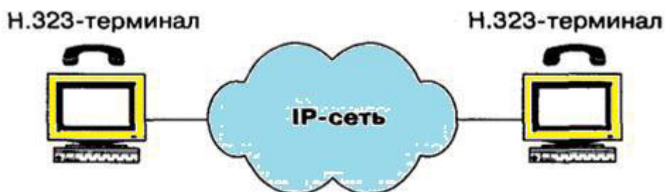
Рис. 3.8. Упрощенный сценарий "компьютер-компьютер"
