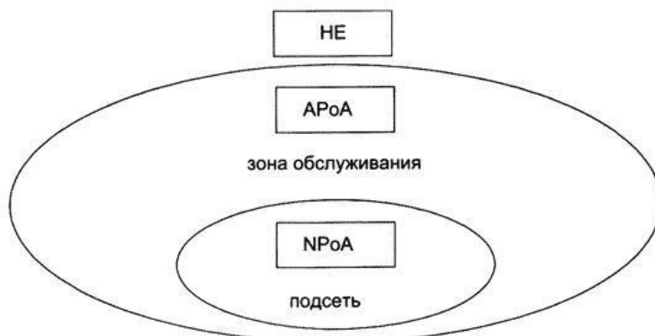
Рис. 5.1. Функциональные элементы, вовлеченные в обслуживание абонента при мобильности
