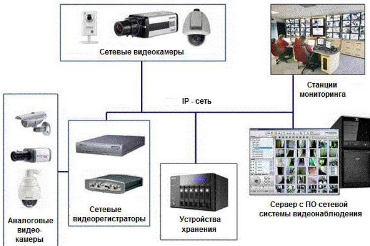
Рис. 6.2. Структурная схема сетевой системы видеонаблюдения.
