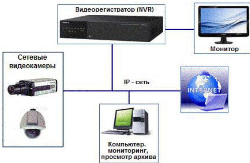
Рис. 6.18. Вариант системы видеонаблюдения на базе сервера
